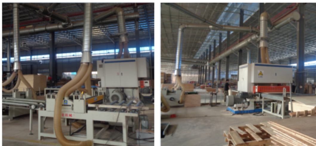
图 4-1 密闭集尘设备及吸尘软管示意图
